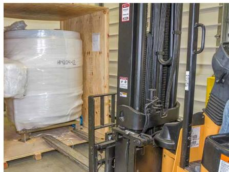
Figura 2.20. Colocación de la carretilla elevadora bajo el S.U.M.
