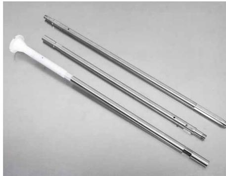
Figura 2.5. Eje motor de varios segmentos.
