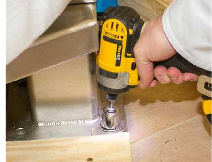
Figura 2.19. Retirada del perno hexagonal con un taladro de retención.
