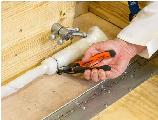
Figura 1.17. Corte de las correas que fijan el eje motor.
