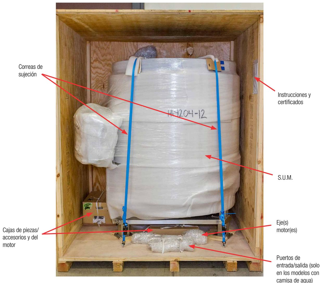
Figura 2.3. Interior de la caja de un S.U.M. de 2000 I.
