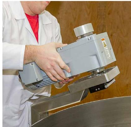
Figura 2.26. Alineación del motor con el montaje del motor.
