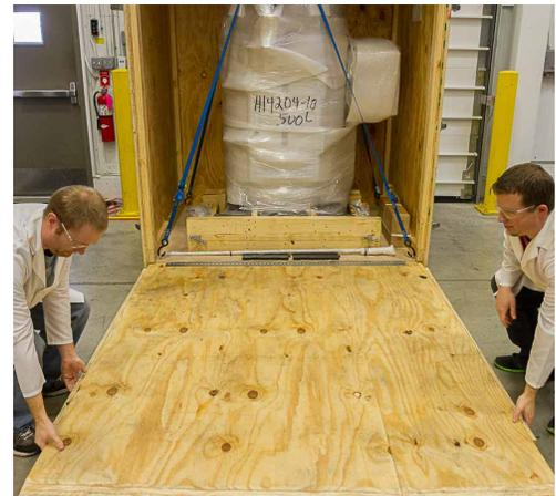
Figura 1.13. Descenso de la puerta de la caja para crear una rampa.
