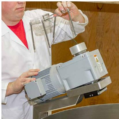
Figura 2.27. Colocación de la cubierta del tapón del motor y de los pernos sobre el motor y el montaje.
