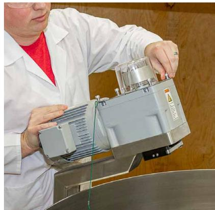
Figura 2.28. Apriete a mano de los pernos del motor y el montaje.
