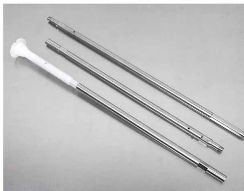
Figura 1.3. (Izquierda) Eje motor de varios segmentos.
