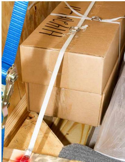
Figura 1.19. Ubicación de la caja de piezas y accesorios en el interior de la caja.
