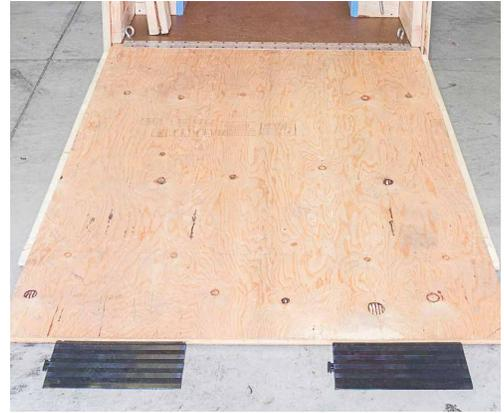
Figura 1.16. Insertos para rampa en la parte inferior de la rampa.
