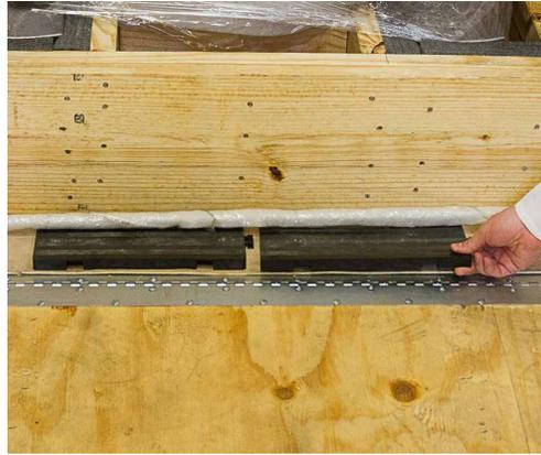
Figura 1.15. Insertos para rampa en la caja.
