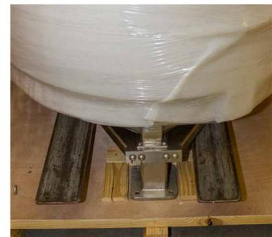
Figura 2.21. Horquillas introducidas hasta el fondo de la caja.
