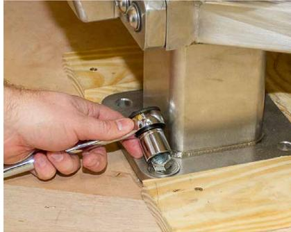
Figura 2.18. Retirada del perno hexagonal con un trinquete.
